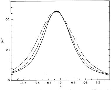
FIGURE 12. Effect of turbulent Reynolds number on  $|\hat{w}|^2$ ;  $\overline{\alpha} = 0.2$ ,  $\overline{\omega} = 0.265$ . ....,  $R_T = 500$ ; --,  $R_T = 300$ ; --,  $R_T = 150$ .
