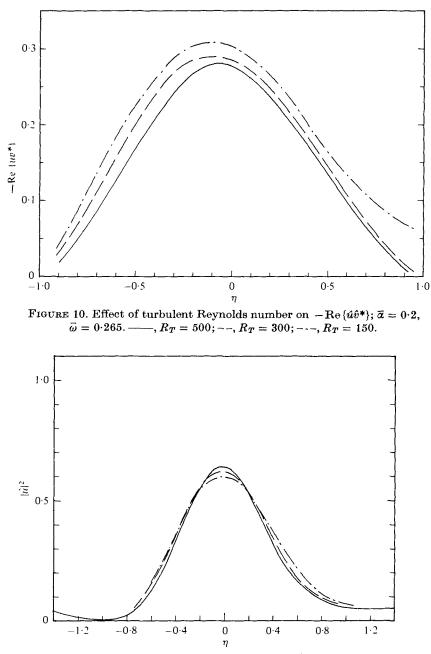
FIGURE 11. Effect of turbulent Reynolds number on  $|\dot{u}|^2$ ;  $\bar{\alpha} = 0.2$ ,  $\bar{\omega} = 0.265$ .  $----, R_T = 500; --, R_T = 300; ---, R_T = 150$ .
